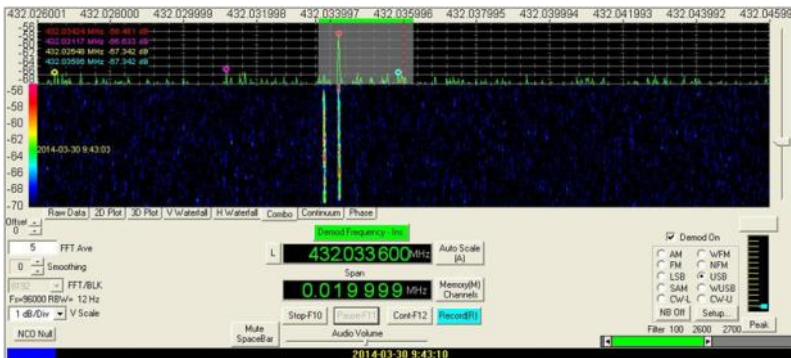
CW signaal DLOSHF met hoog vermogen
