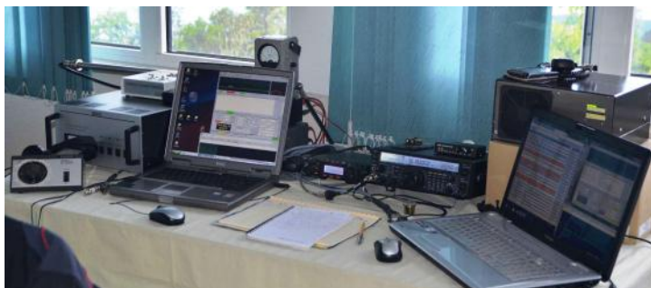
De "SO2R" opstelling voor 4 en 2 meter
